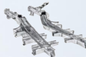
左右前纵梁焊合总成
